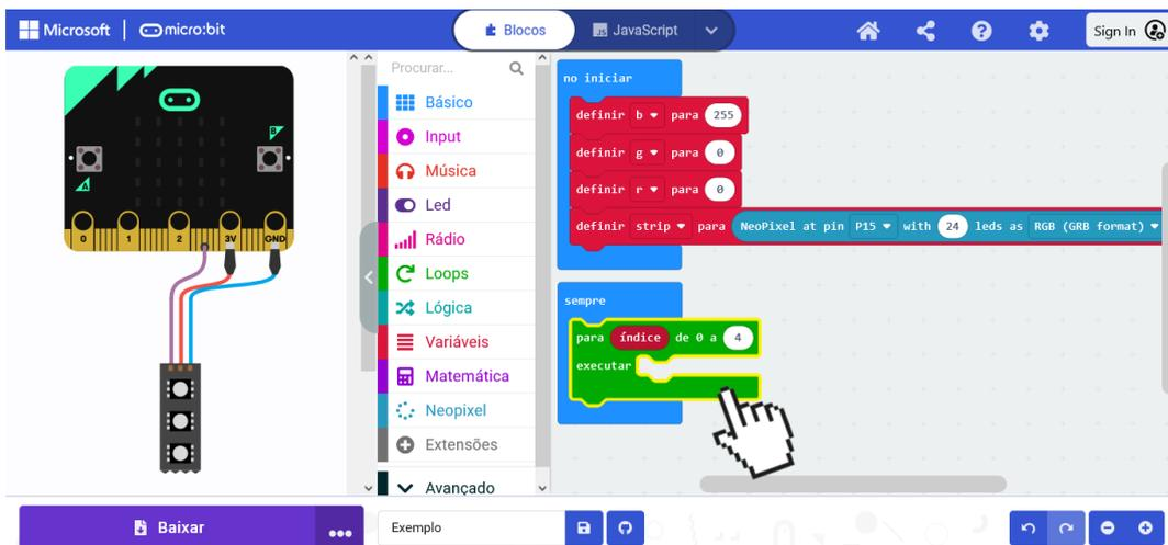
Figura 24.22: Montando um bloco de repetição.
